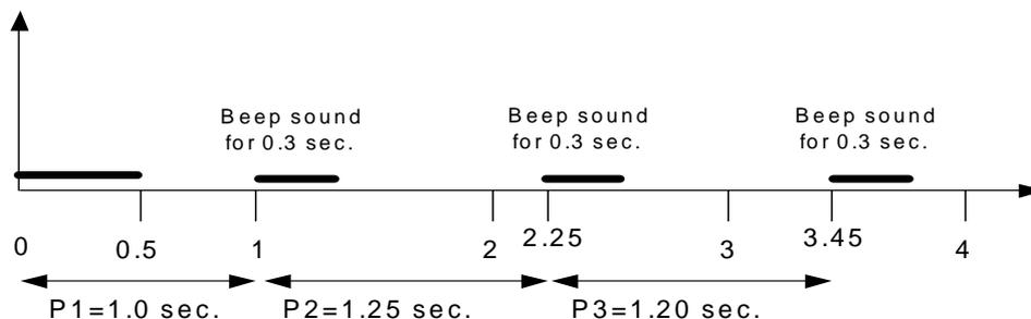
Dieses Beispiel zeigt 3 „PAR“-Zeiten, die durch ein einziges Start-Signal aktiviert werden. Insgesamt ertönen 4 Signaltöne vom Timer: 1 Startsignal und 3 „PAR“-Signale.
